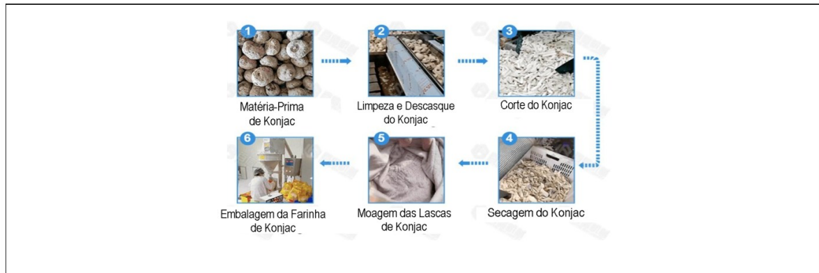
Figura 13: Fluxo de processamento do konjac
